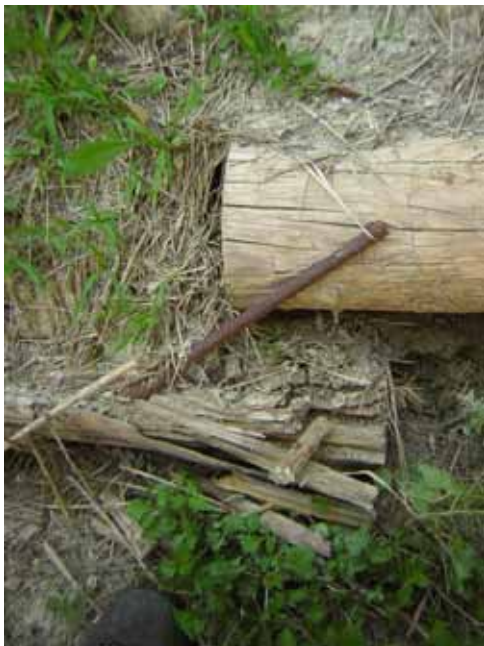
Foto 7. Diano- cedimenti del legno in corrispondenza delle chiodature. A destra, struttura collassata su se stessa.
